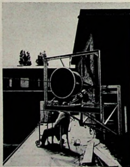
Bild 2. Einmessen der Goubau-Leitung auf dem Gelände des Hamburger Großsenders. Diese Leitung diente zur Energieübertragung zwischen dem 1-kW-Fernsehsender in Kanal 18 (502...510 MHz) und der Antenne (Foto: Hans-Ernst Müller)
